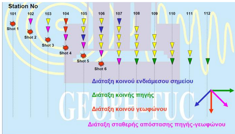
Εικόνα 3.1: Σχηματική παράσταση διαφόρων διατάξεων πηγής - δέκτη.
